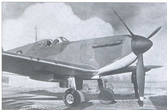
Пристрелка пулеметов на "Спитфайре". Хорошо видны пулеметные порты в передней кромке крыла
