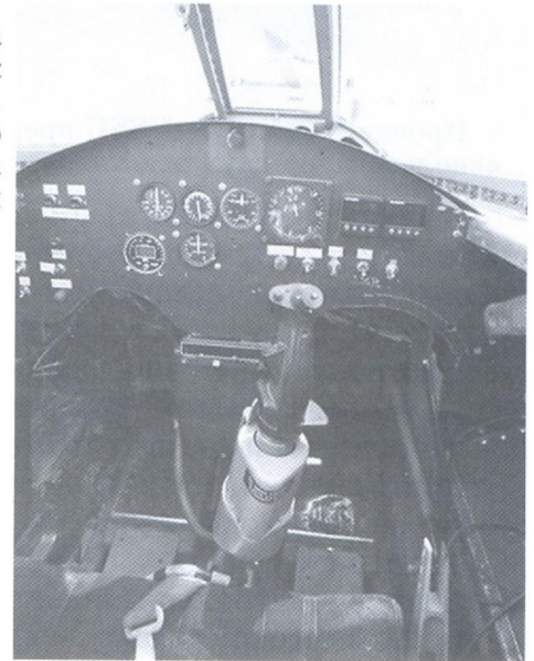
Кабина осталась как на самолете. Вместо руля — ручка управления
