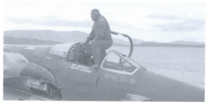
Кабина осталась как на самолете. Вместо руля — ручка управления
